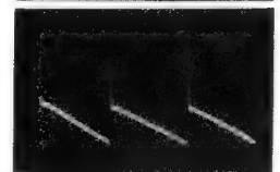
Bild 101. Sägezahnspannung mit Rücklaufspitze an der Anode der Röhre R 17
